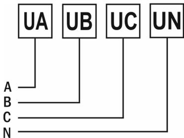
Рис. 8 – Подключение напряжения напрямую (трехфазная цепь с нейтралью)
