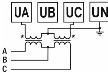
Рис. 11 – Подключение трансформатора напряжения (трехфазная цепь без нейтрали)
