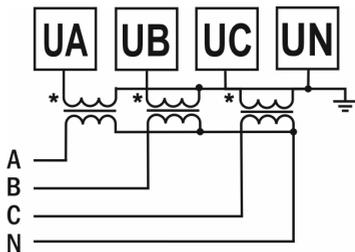
Рис. 9 – Подключение трансформатора напряжения (трехфазная цепь с нейтралью)
