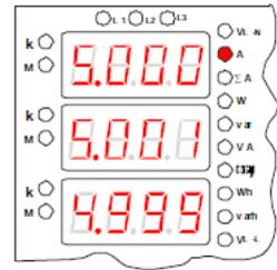
Рис. 16 – Пример работы прибора. Режим отображения силы тока.
