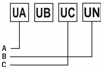
Рис. 10 – Подключение напряжения напрямую (трехфазная цепь без нейтрали)
