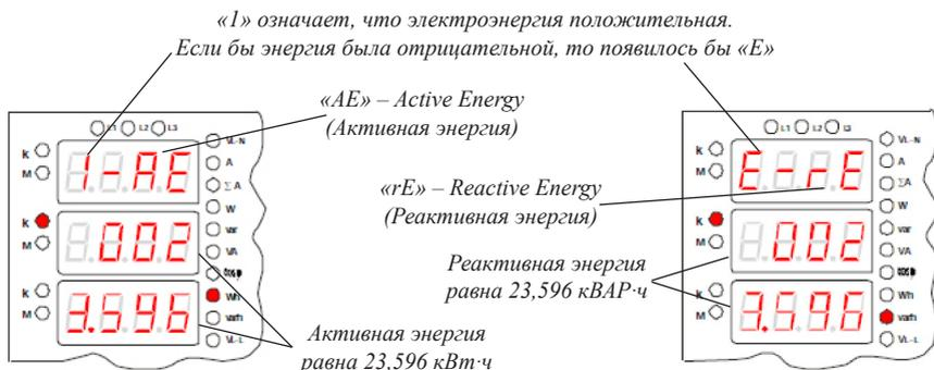
Рис. 18 – Примеры работы прибора. Режимы отображения энергии.
