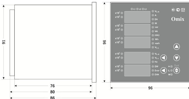
Рис. 3 – Размеры прибора
